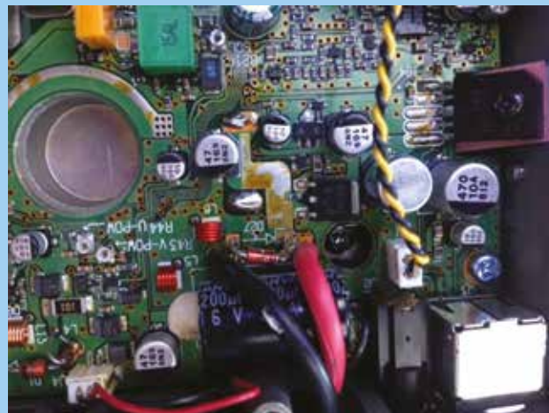
Figura 4: Placa do rádio de VHF. O diodo entre os cabos de alimentação estava em curto e foi substituído
